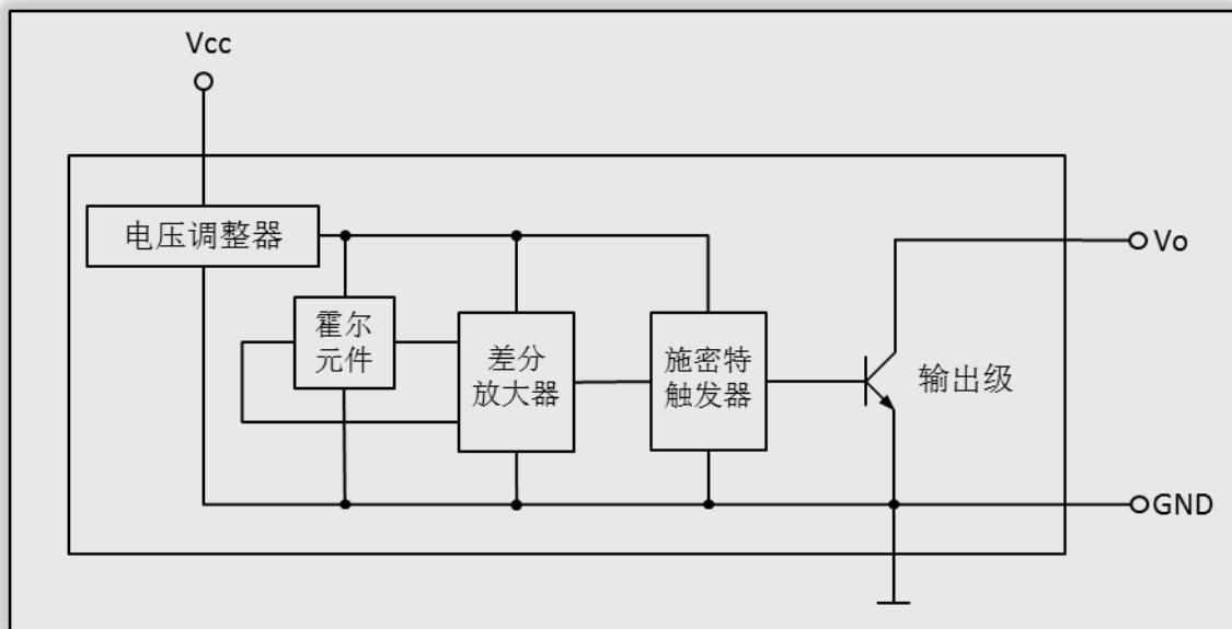
AH3041N 霍尔传感器是一种以双磁极激励的单端数字输出霍尔集成电路，输出信号具有锁存功能。传感器芯片内置有反向电压保护器、电压调整器、温度补偿电路、霍尔电压发生器、信号放大器、史密特触发器和集电极开路输出驱动器等电路单元。性能优良的电压调整器和温度补偿电路，确保传感器在较宽的电压范围和温度范围内稳定地工作，反向电压保护电路避免了传感器受到反向电压的损伤。
