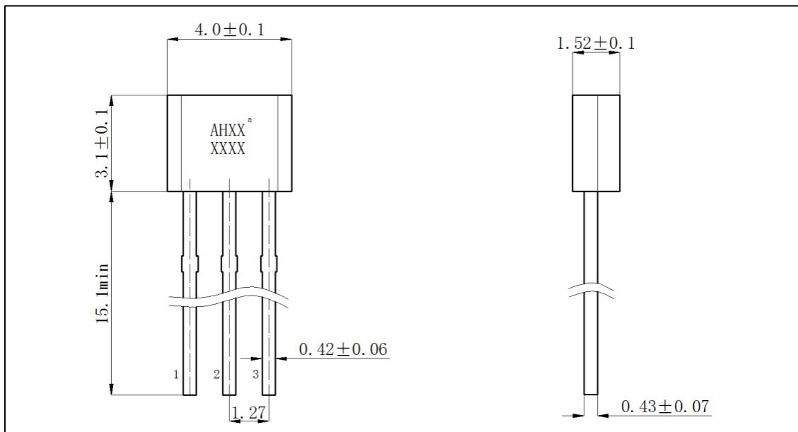
注 : 封装外形图中 , 引脚 1 为 Vcc , 引脚 2 为 GND , 引脚 3 为输出端。
